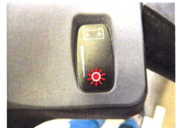
Indikator rot leuchtet
